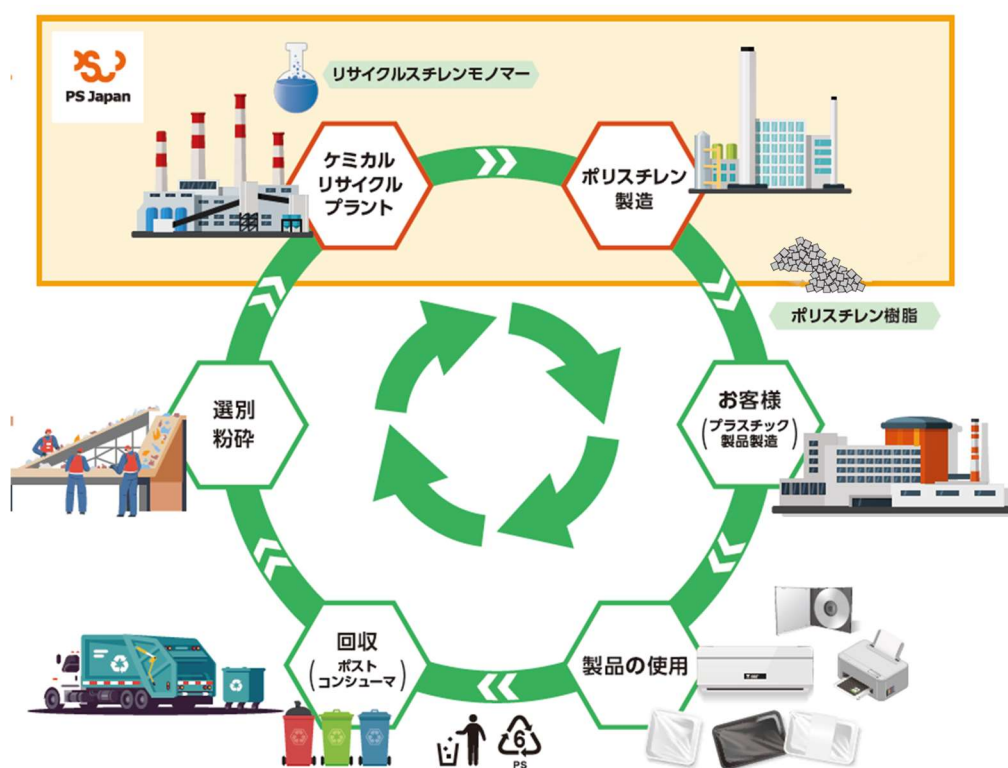
ポリスチレンのケミカルリサイクル(資源循環)の模式図
